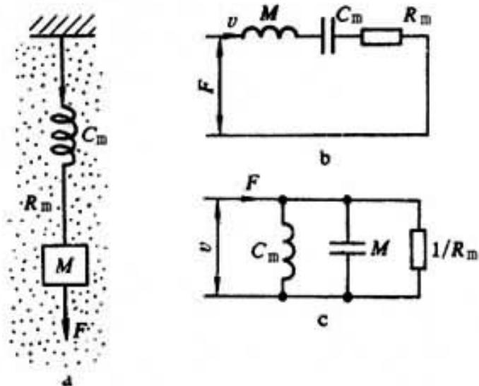
图1 机械振动系统及其等效力学线路
