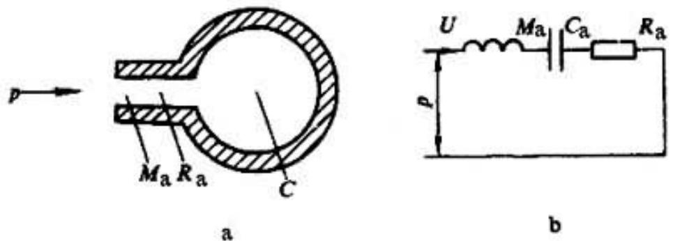
图2 声振动系统及其等效声学线路
